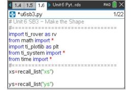
4. これで、Roverのルートをプログラムする準備が整いました。Rover は点(0,0)からスタートすることを忘れないでください。最初の点が 原点ではない可能性があるため、マーカーの挿入を一時停止する前 に、Roverを最初の点に移動させます。最初の点は(xs[0], ys[0])です。 次のステートメントを使います。
